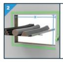
Kleben Sie den Durchbruch rundum mit Klebeband ab, mit einen Abstand von 25 mm zum Rand. Messen Sie dann den Durchbruch und die Durchführungen, und zeichnen sie diese auf der Multimastic FB Brandschutzplatte an.
