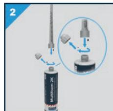
2 Halten Sie die Kartusche vertikal mit der Kappe nach oben, drehen Sie die Verschlusskappe ab und montieren den mitgelieferten Mischeraufsatz darauf.
