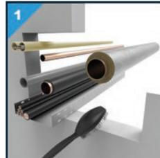
1 Sorgen Sie dafür, dass die Durchführungen und der Durchbruch frei von Staub, Schmutz und Fett sind. Falls erforderlich, kann die andere Seite der Öffnung mit einer Schalung aus Karton, Plastikfolie oder Schalungsband abgedichtet werden.
