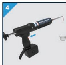
4 Halten Sie die Kartuschenpistole schräg nach oben, so dass die beiden Komponenten gleichzeitig aus dem Mischeraufsatz gedrückt werden. Werfen Sie das anfängliche, unvermischt Material weg.
