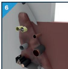
6 Nach ca. 2 Minuten können überstehende Schaumreste mit einem geeigneten Messer abgeschnitten werden.
